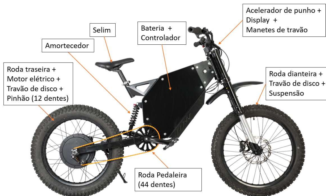
Figura 32 – Componentes da E-bike .
