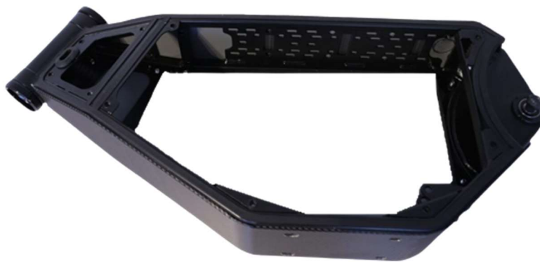
Figura 27 – Compartimento que permite alojar a bateria. Fonte: [44].
