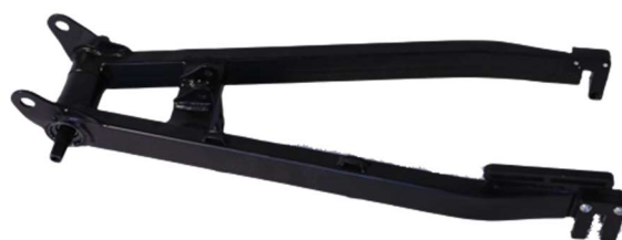
Figura 29 – Forquilha oscilante de suporte da roda motora. Fonte: [44].
