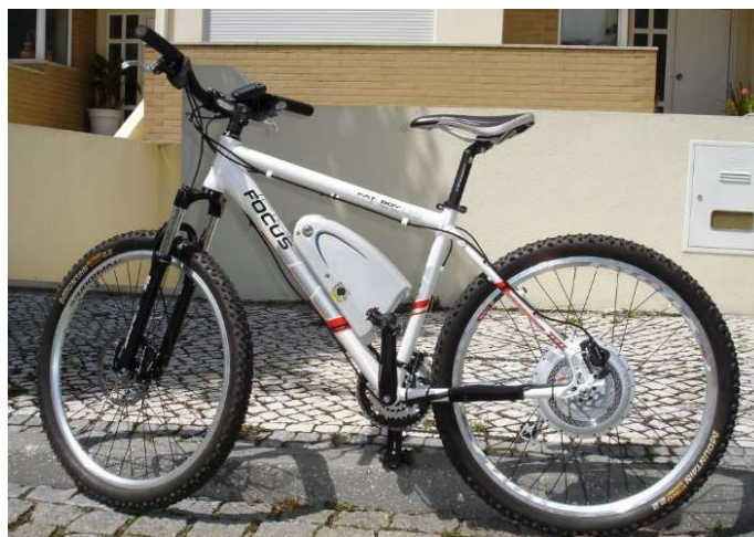
Figura 4 – Conversão de bicicleta tradicional em E-bike com kit da BionX. Fonte: [14].
