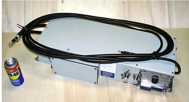
Fig. 29– Controlador Simovert 6SV.
