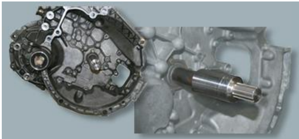
Fig. 12 – Eixo acoplador Motor -Caixa de velocidades.
