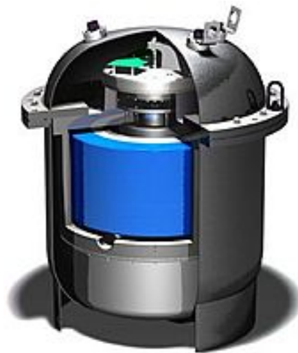
Figura 9 - Aspecto de uma Bateria Electromecânica com massa inercial cilíndrica, em material compósito.
