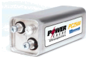
Figura 7 - Super condensador com 2500 F (7200 J) (dim. : 160x60x60 mm, peso : 720 g)
