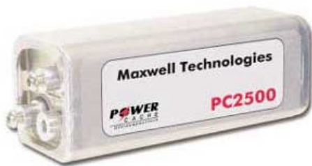
Figura 9 - Super condensador com 2500 F (7200 J). Com dimensões: 160x60x60 mm, e peso: 720 g). Fonte: www.powercache.com .
