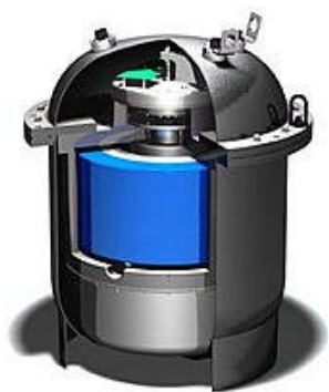
Figura 8 - Aspecto de uma Bateria Electromecânica com massa inercial cilíndrica, em material compósito.
